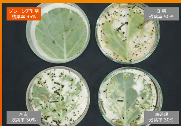
2021年日産化学生物科学研究所（社内試験） 【試験方法】シロイチモジヨトウ4齢幼虫 虫体散布2.5ml /シャーレ、処理1時間後餌入、42時間後撮影
