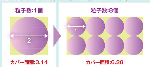
◎仮に直径「2」の粒子1個を、直径「1」の粒子に碎いた場合、粒子は8個となり(体積は同じ)、付着面積を同半径の円と仮定すると、カバーする面積は増えます。
